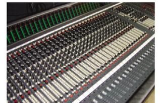
그림 215 In-line console
